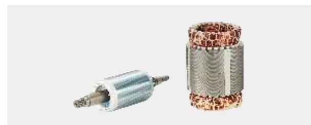
起升电机高性能电机，重量轻，体积小，转速可到3000 R.P.M。启动转矩高，能效高，接电持续率达60%，满足高频率搬运的需求。防护等级IP55。绝缘等级F级。
