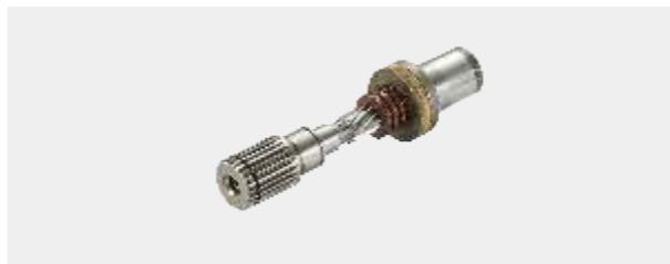
超离合器--集成在传动齿轮轴上，起到超载保护功能。保持扭矩高达安全载荷的1.4倍免维护设计，超载力矩可调。
